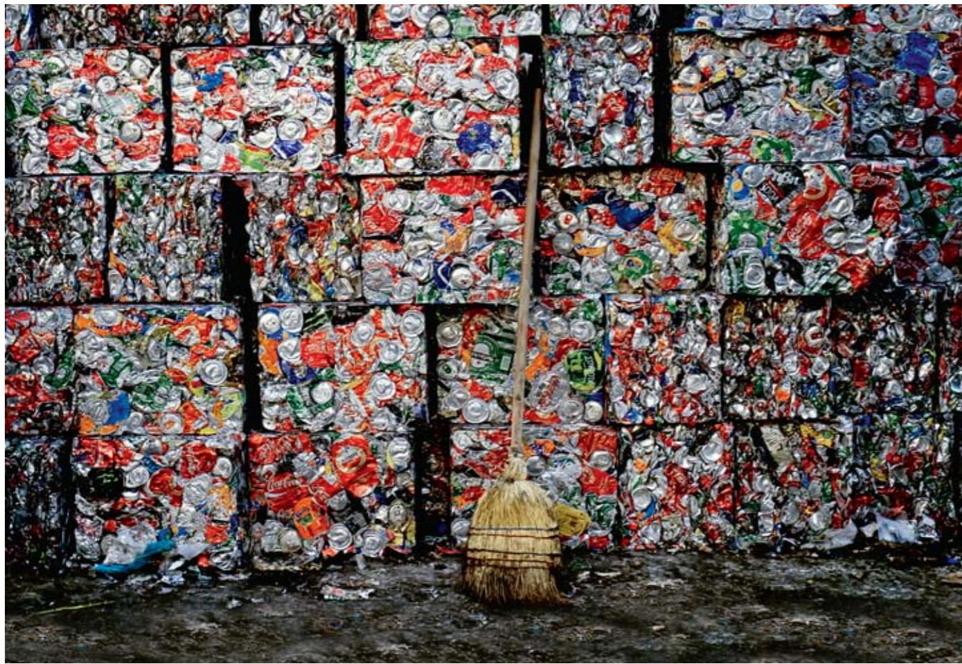
Συμπιεσμένο αλουμίνιο, από τα ελάχιστα αξιοποιήσιμα υλικά που προκύπτουν από την επεξεργασία.
